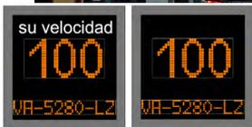
Integra en una solución única nuestra cámara Traffic Eye junto con un panel informativo que permite mostrar la velocidad de los vehículos junto con la lectura de las placas de los vehículos.
